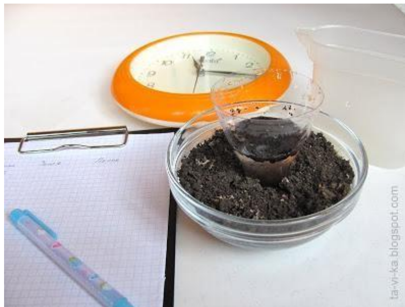
Считаем время, за которое вся вода из воронки уйдет в землю
