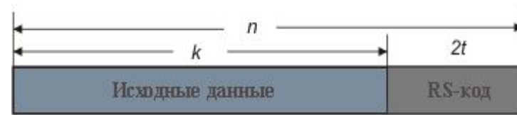
Структура систематического кодового слова Рида — Соломона (сверху)
