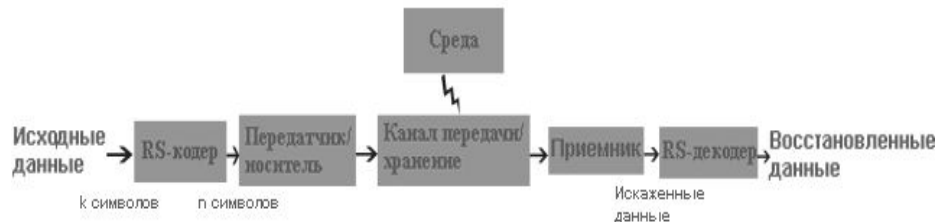
Схема кодирования с использованием кодирующих устройств (Слева)
