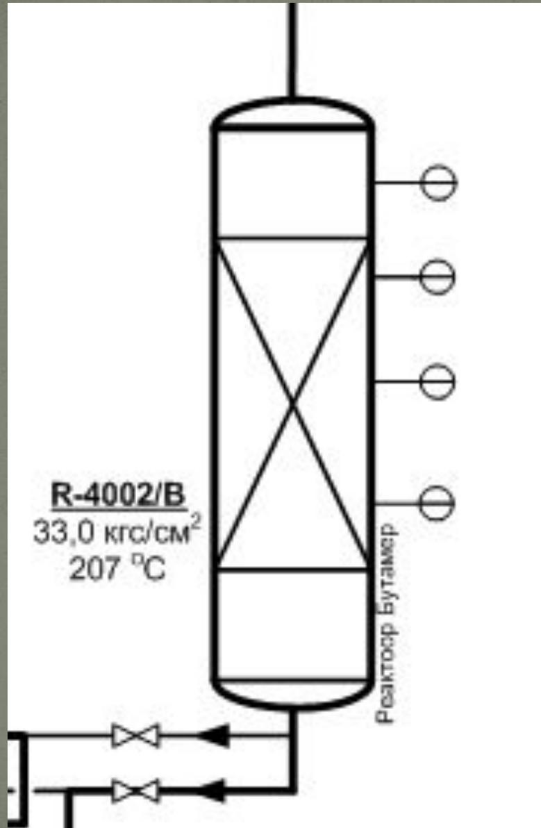
Реактора R-4002 А/В представляют собой вертикальные аппараты, заполненные катализатором изомеризации I-120. Направление движения сырья через слой катализатора - сверху вниз.
