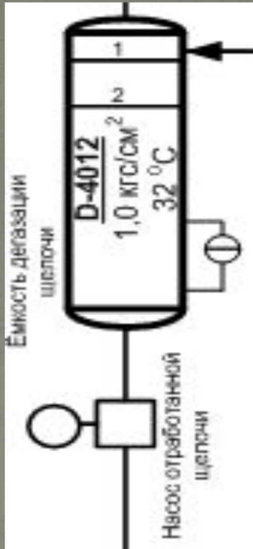
Ёмкость дегазации щёлочи D-4012 представляет собой емкостной аппарат с двумя клапанными тарелками.
