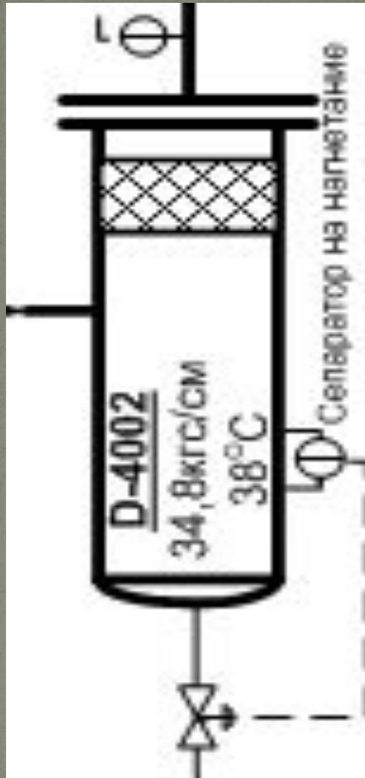
Сепараторы D-4001 и D-4002 представляют собой вертикальные ёмкости с установленным в верхней части сетчатым отбойником. В сепараторах D-4001 и D-4002 происходит отделение газового конденсата от водорода.
