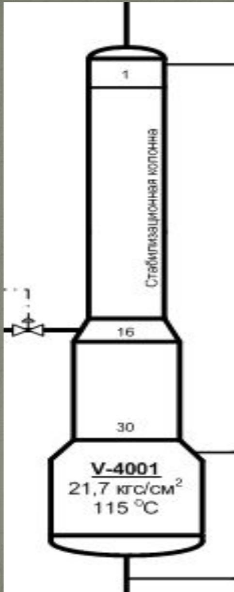
Стабилизационная колонна V-4001 представляет собой колонный аппарат с 30 клапанными тарелками. В колонне V-4001 от продукта изомеризации отгоняется водород, углеводороды C<sub>1</sub>-C<sub>3</sub> и хлороводород, образовавшийся в результате реакции между перхлорэтиленом и водородом.
