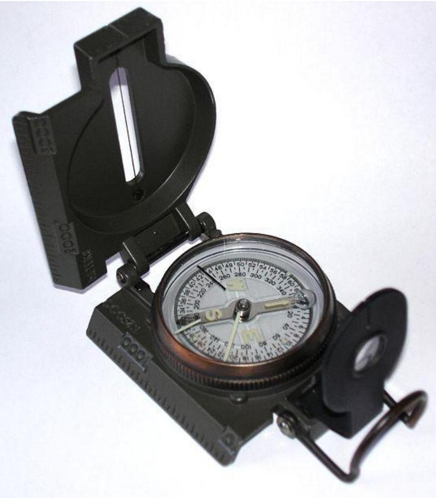
Принцип действия основан на взаимодействии поля постоянных магнитов компаса с горизонтальной составляющей магнитного поля Земли. Свободно вращающаяся магнитная стрелка поворачивается вокруг оси, располагаясь вдоль силовых линий магнитного поля. Таким образом, стрелка всегда параллельна направлению линии магнитного поля.
