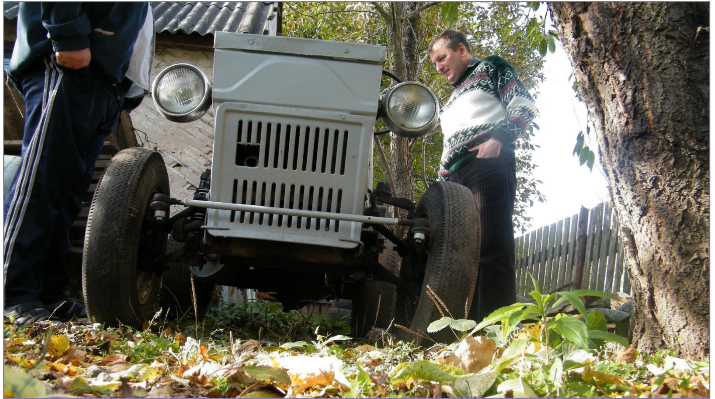
Міні-трактор із одноциліндровим ДВЗ «Зид».
