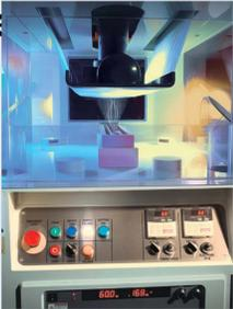
Рис. 1. Бесфильтровая установка NanospiderTM NS LAB 200S на которой производилось ЭФ.
