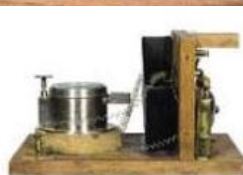
5 Прибор для обнаружения и регистрации электромагнитных колебаний – первый в мире радиоприемник А. С. Попова. 1895 г.
