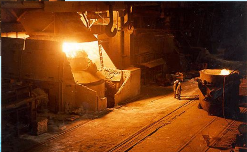
Конвертер (слева) и сталеразливочный ковш (справа)
