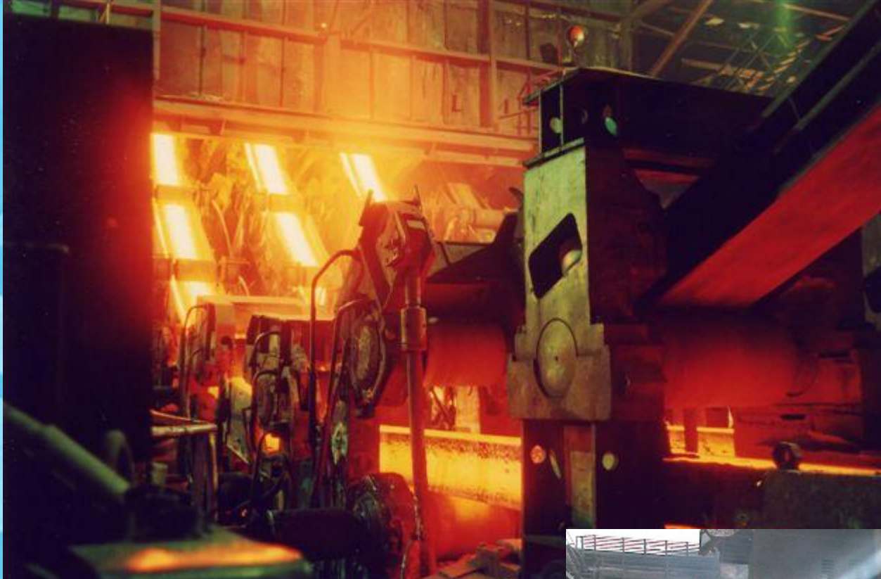
Разливка стали в Машине непрерывного литья заготовок (МНЛЗ)
