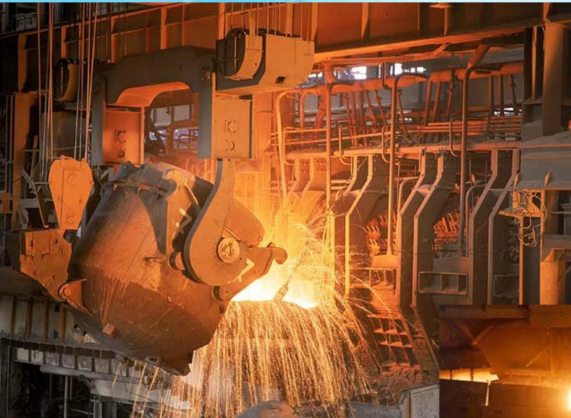
*Заливка чугуна в конвертер*
