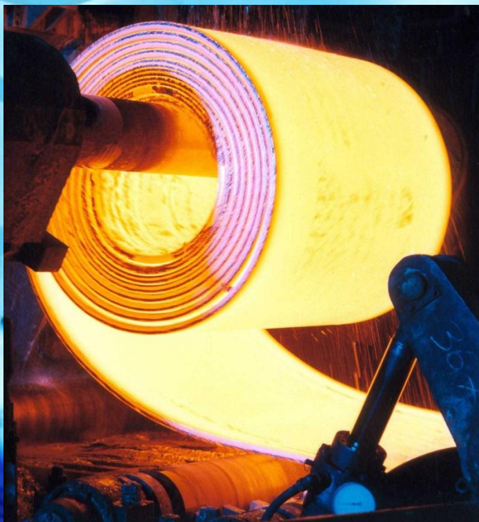
Намоточное устройство прокатного стана
