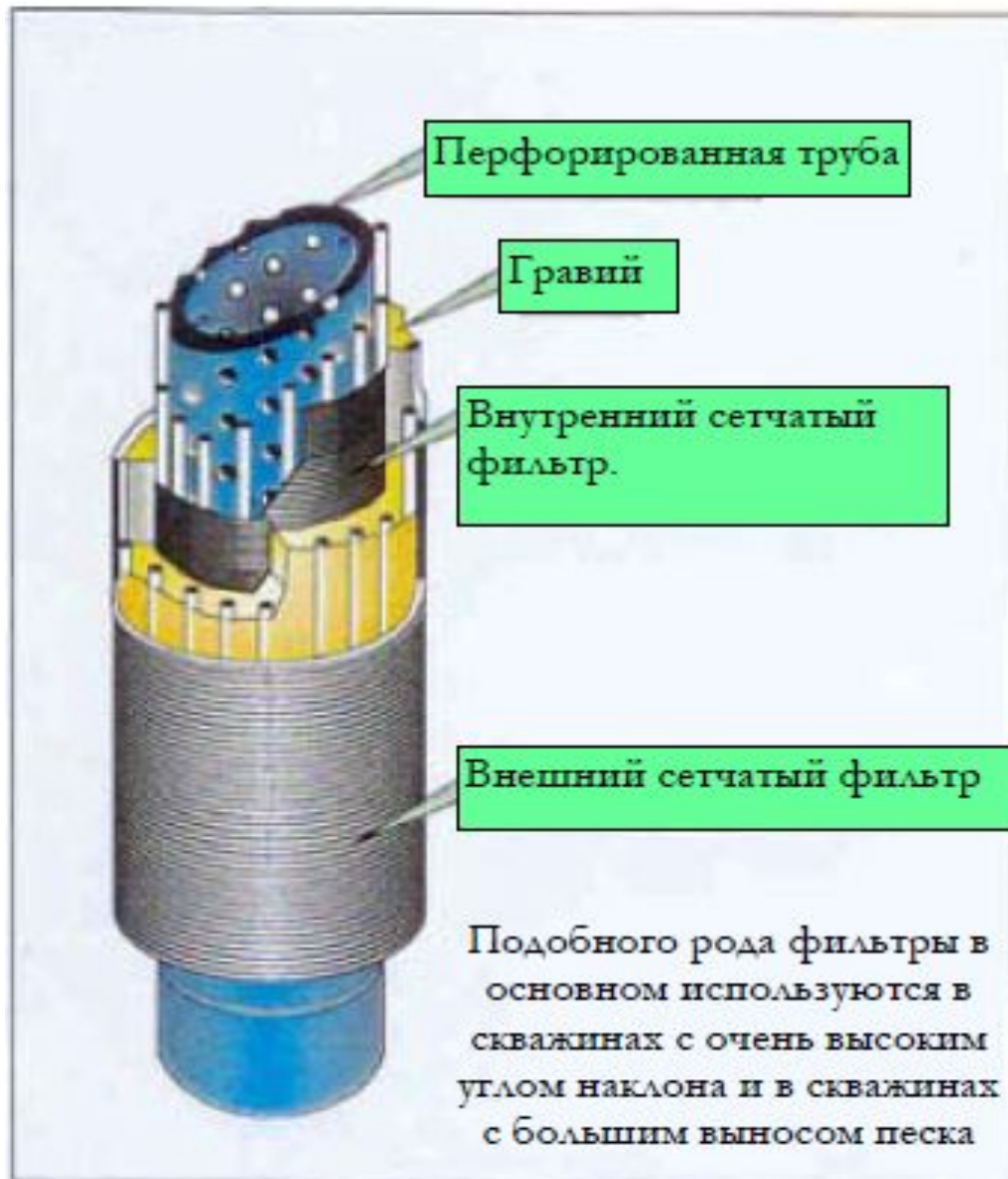
Внутренний (набивной) гравийный фильтр
