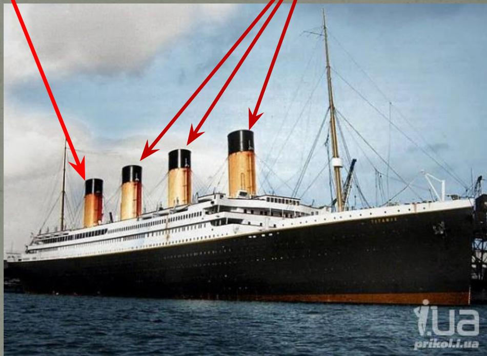
Лайнер имел 4 трубы, диаметр каждой из которых был 7,3 м, высота — 18,5 м. Три первые отводили дым из топков котлов, четвёртая, расположенная над отсеком турбины, выполняла функции вытяжного вентилятора, к ней был подведён дымоход для судовых кухонь.
