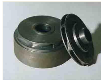
Рабочие органы типового погружного электронасоса
