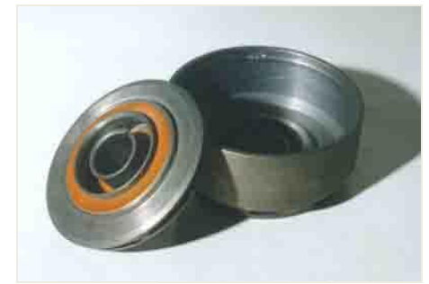
Рабочие органы типового погружного электронасоса
