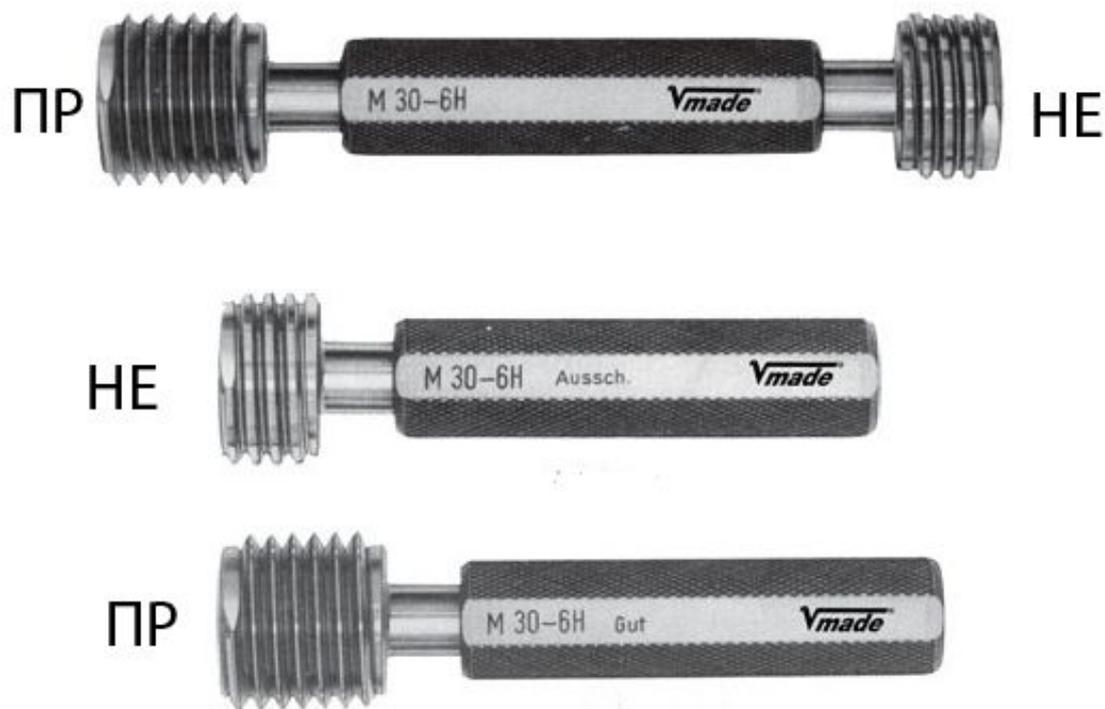
Свинчиваемость проходного калибра-пробки с гайкой означает, что средний диаметр резьбы гайки не выходит за установленный наименьший предельный размер, а погрешности угла профиля и шага резьбы гайки компенсированы соответствующим увеличением среднего диаметра. Вместе с тем проверка данным калибром гарантирует, что наружный диаметр гайки не меньше наружного диаметра болта
