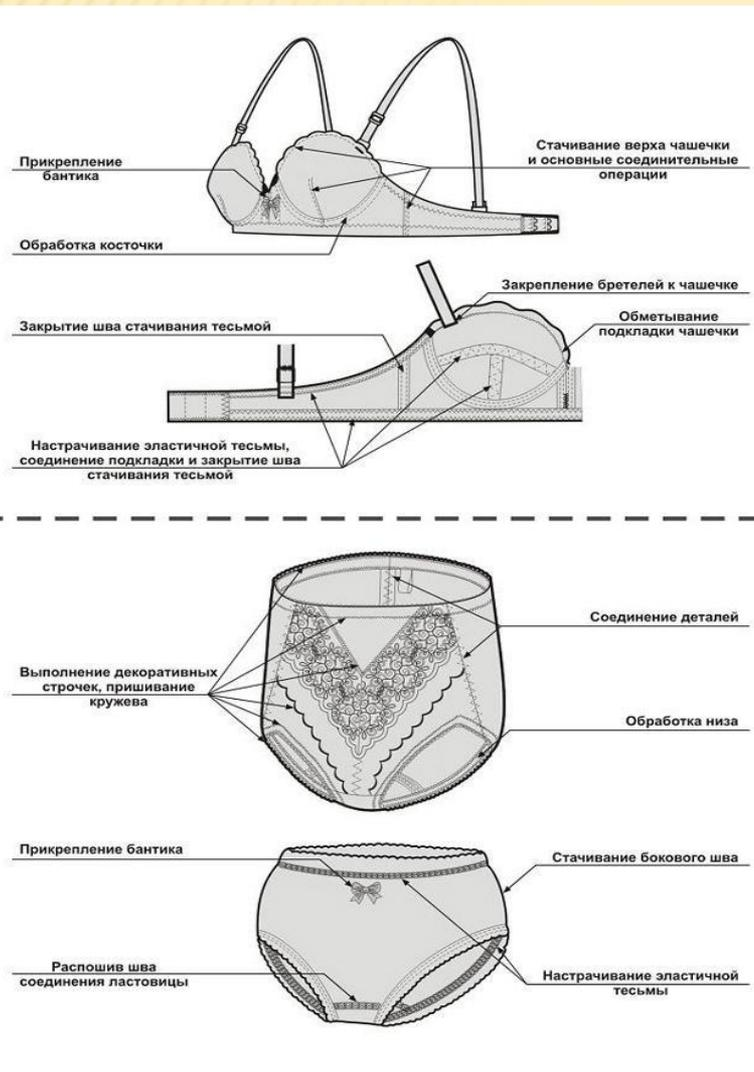
Технологический процесс обработки корсетных изделий можно разделить на 3 группы работ.
