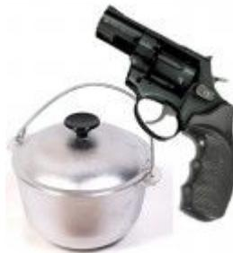
*Силумин — сплав алюминия с кремнием (4-22 % Si, основа — Al)*
