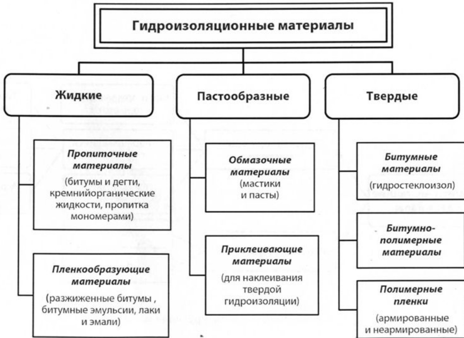
Схема 14.2 – Разновидности гидроизоляционных материалов
