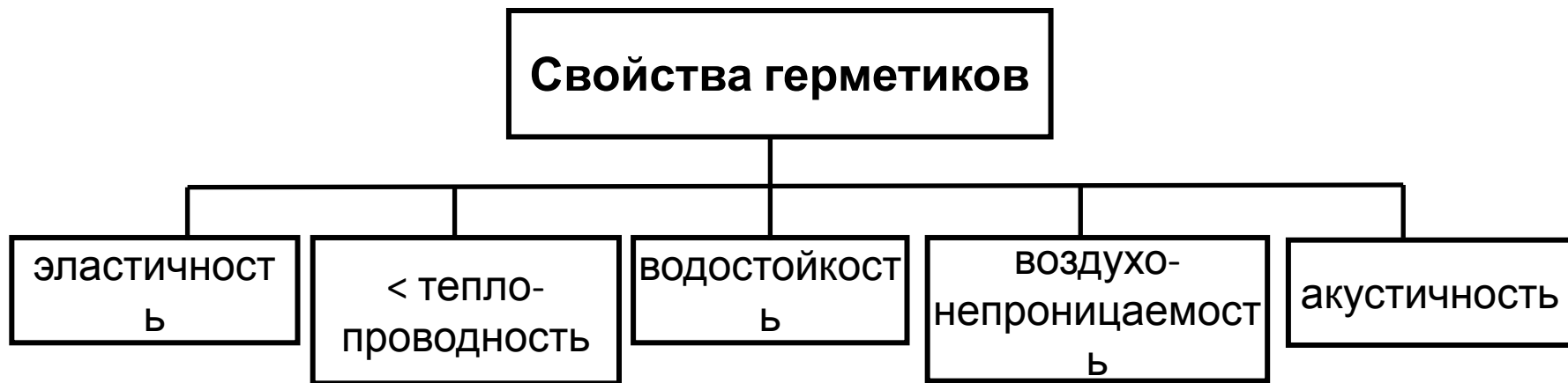
Схема 14.6 – Свойства герметиков
