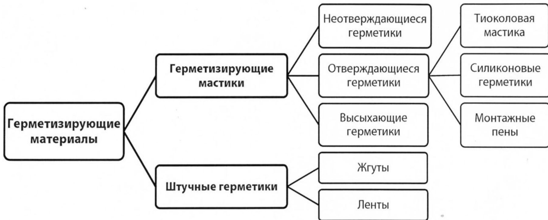
Схема 14.5 – Герметизирующие материалы
