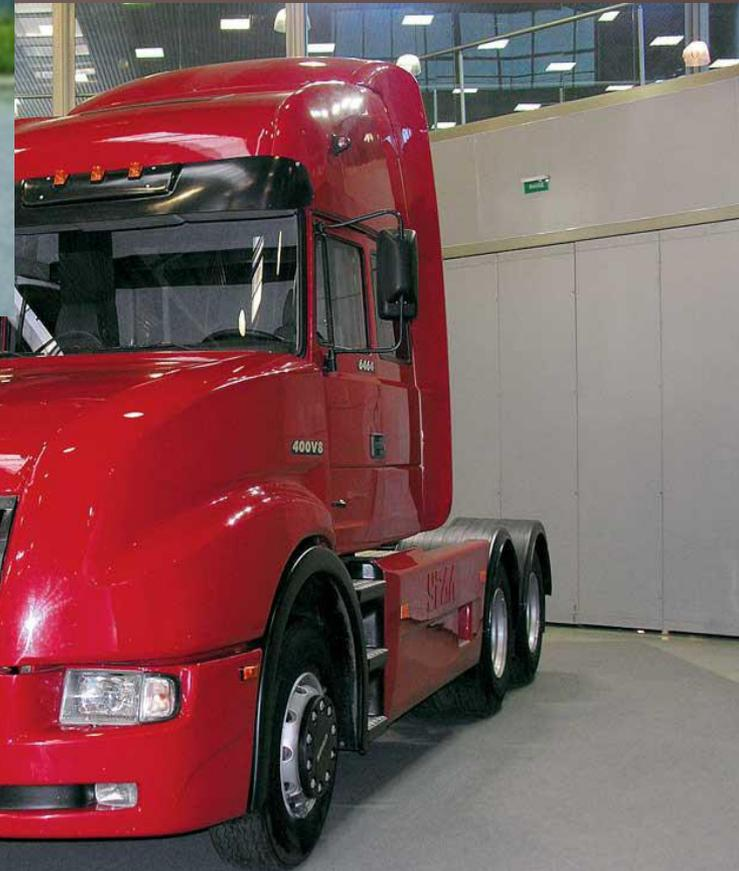
Миасские грузовики способны эффективно работать при температурах окружающего воздуха от  $-50$  до  $+50^{\circ}\text{C}$ . Автомобили «УРАЛ» имеют высокую ремонтпригодность и рассчитаны на безгаражное
