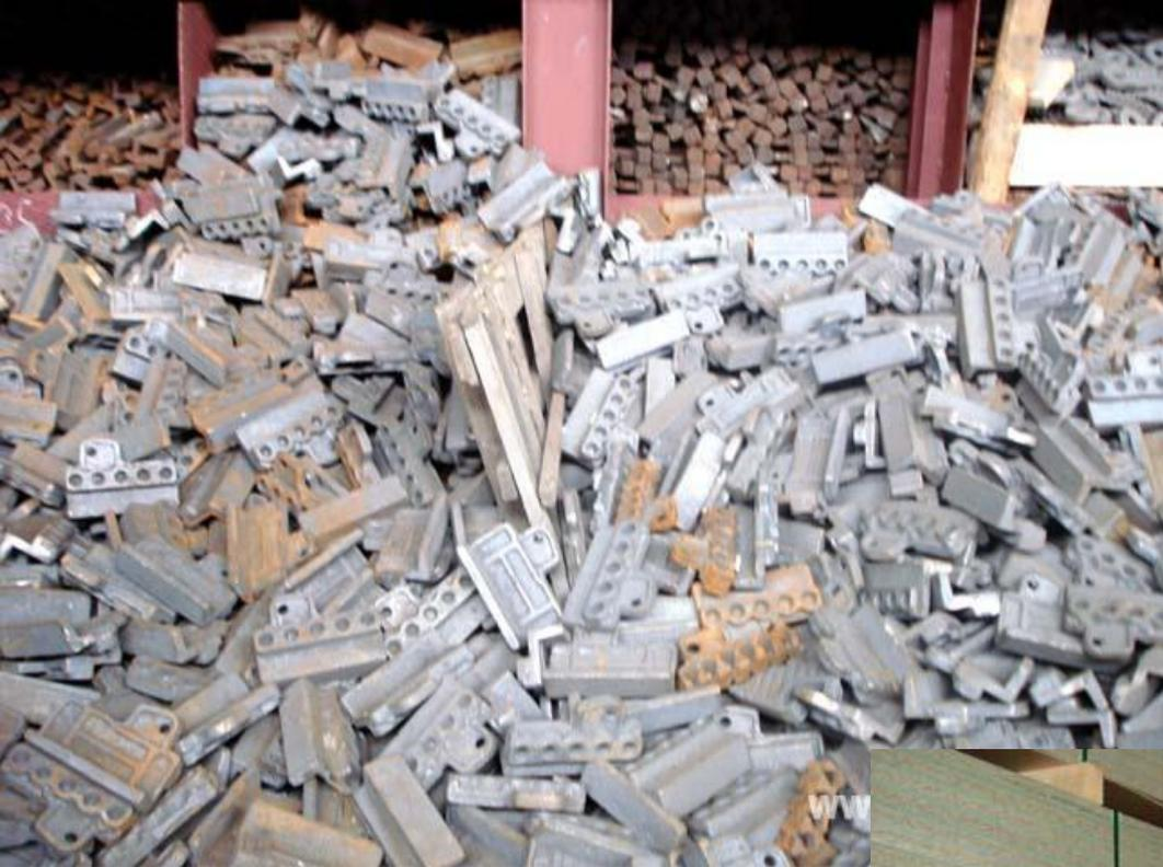
Склад металлических заготовок. Беспорядок приводит к повреждению деталей.
