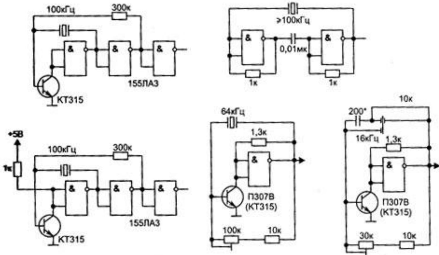
Так как кварцевый резонатор является законченным электронным компонентом, его частоту можно изменять внешними элементами и схемой включения
