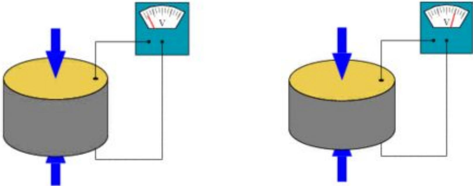
**Пьезоэлектрический эффект** — эффект возникновения поляризации диэлектрика под действием механических напряжений (*прямой пьезоэлектрический эффект*). Существует и *обратный пьезоэлектрический эффект* — возникновение механических деформаций под действием электрического поля.
