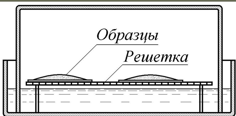
Рис. 3.3. Ванна с гидравлическим затвором
