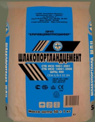
Стекловидная фаза доменного шлака вступает в процессы гидратации и гидролиза с образованием гидроалюминатов и гидросиликатов кальция. Гипс и  $\text{Ca}(\text{OH})_2$  реагируют со шлаковыми составляющими, образуя гидрогеленит и гидрогранаты. При твердении шлакопортландцемента образуются гидросиликаты меньшей основности, чем при твердении портландцемента.
