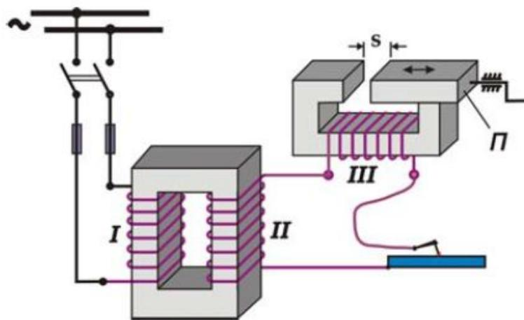
Рис. 3.2. Схема сварочного трансформатора типа СТЭ 34
