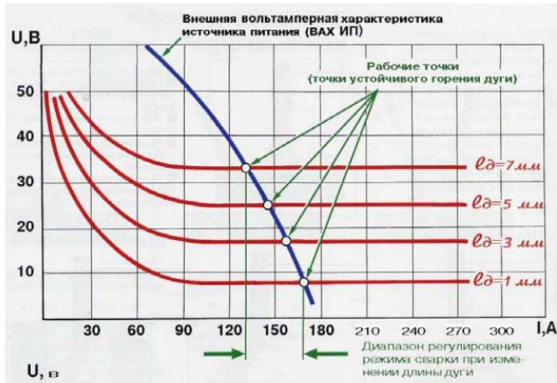
Рис.3.15. Вольт-амперные характеристики сварочной дуги
