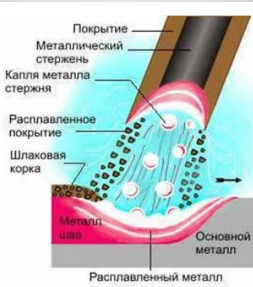
Рис. 3.17. Схема процесса сварки
