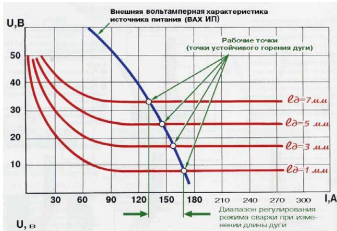
Рис.3.15. Вольт-амперные характеристики сварочной дуги
