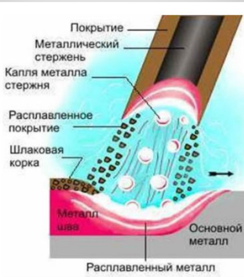
Рис. 3.17. Схема процесса сварки
