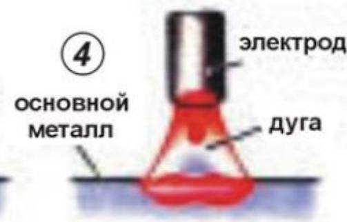
Рис. 3.16. Схема процесса зажигания дуги
