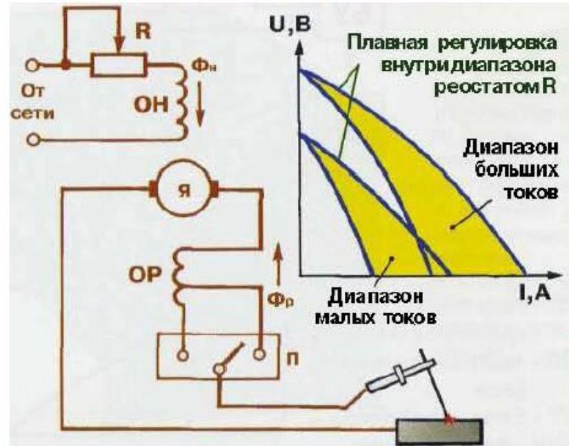
Рис. 3.5. Сварочный преобразователь
