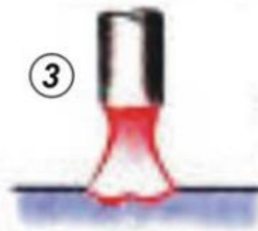
Рис. 3.16. Схема процесса зажигания дуги
