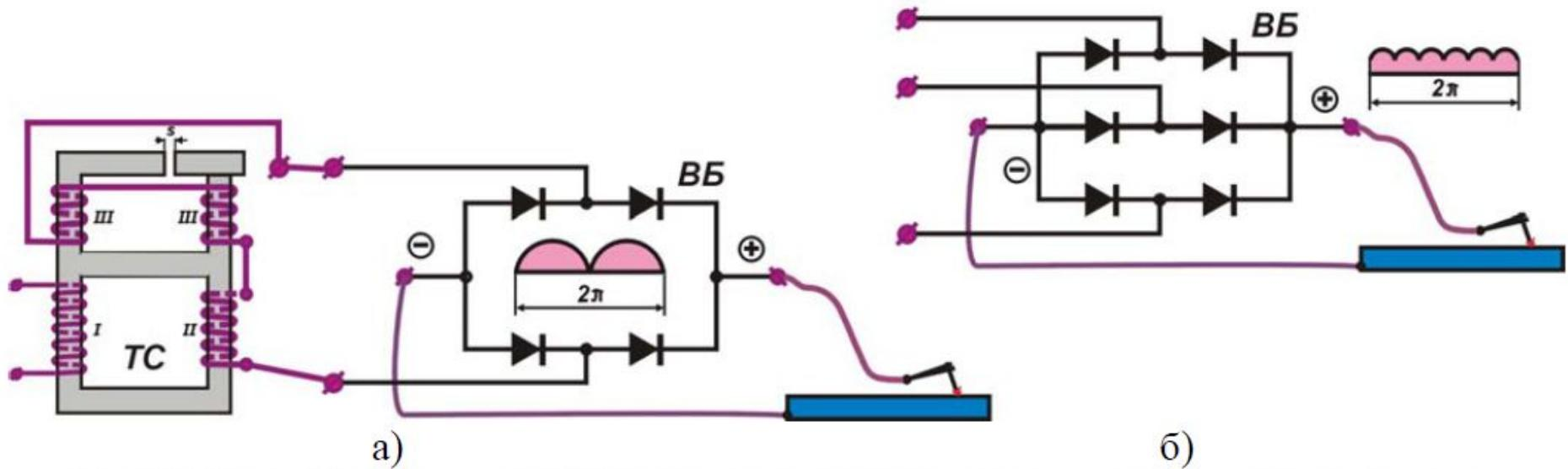
Рис. 3.8. Электрические схемы неуправляемых выпрямителей постоянного сварочного тока.
