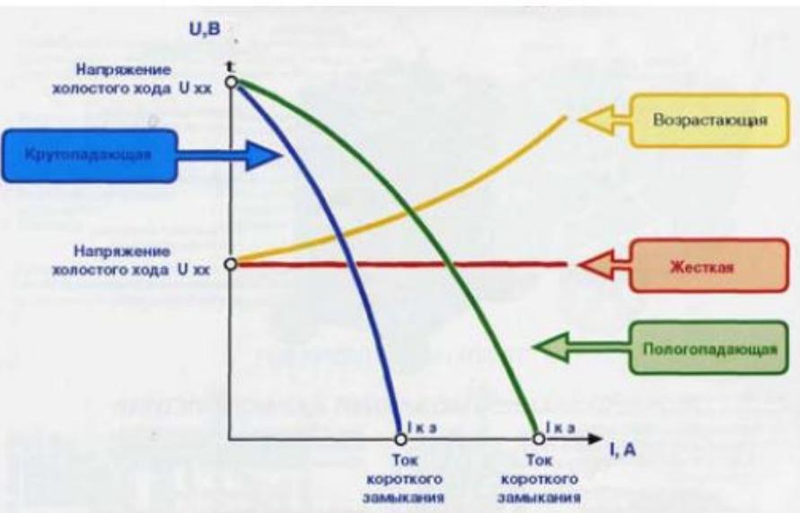
Рис.3.13. Внешние вольтамперные характеристики источников питания
