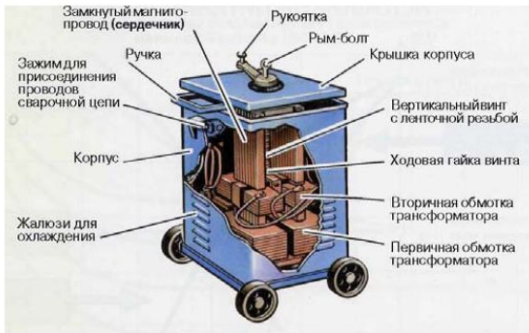
Рис. 3.1. Общий вид и электрическая схема трансформатора типа ТС500 (ТСК500) 1 – магнитопровод; 2 – вторичная (понижающая) обмотка; 3 – сетевая обмотка; 4 – конденсатор; 5 – механизм перемещения вторичной обмотки
