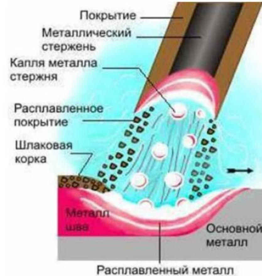
Рис. 3.17. Схема процесса сварки
