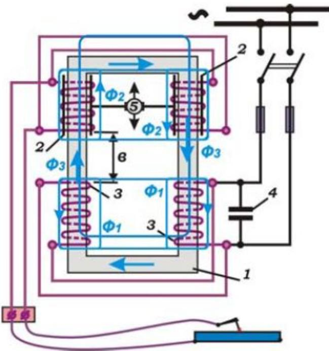
Рис. 3.1. Общий вид и электрическая схема трансформатора типа ТС500 (ТСК500)
