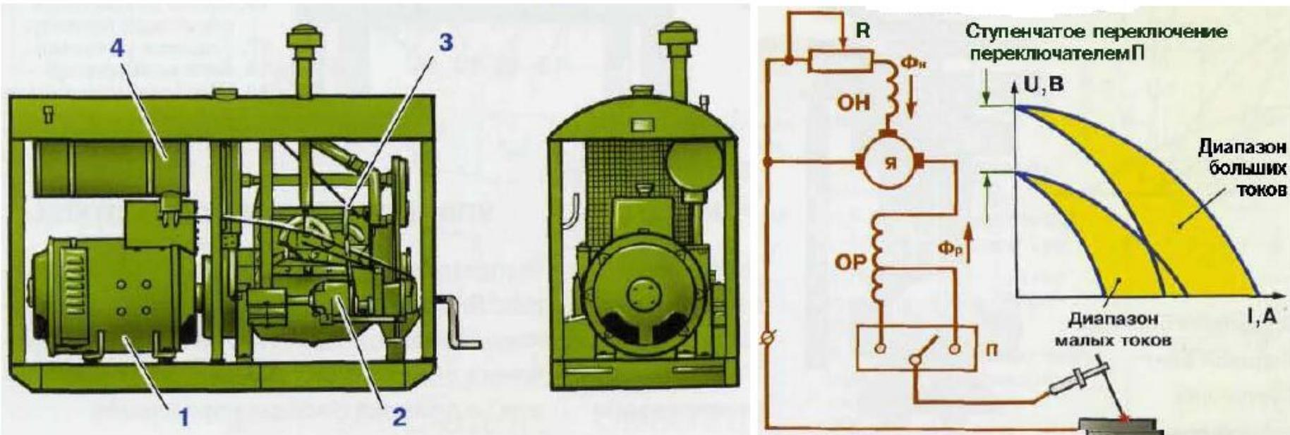
Рис. 3 6. Сварочный агрегат
