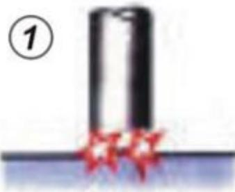
Образование прослойки из жидкого металла
