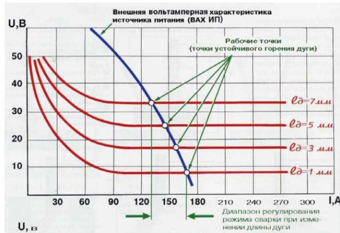
Рис.3.15. Вольтамперные характеристики сварочной дуги
