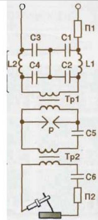
Рис.3.12. Балластный реостат (а) и осциллятор ОССД -300.2 (б).
