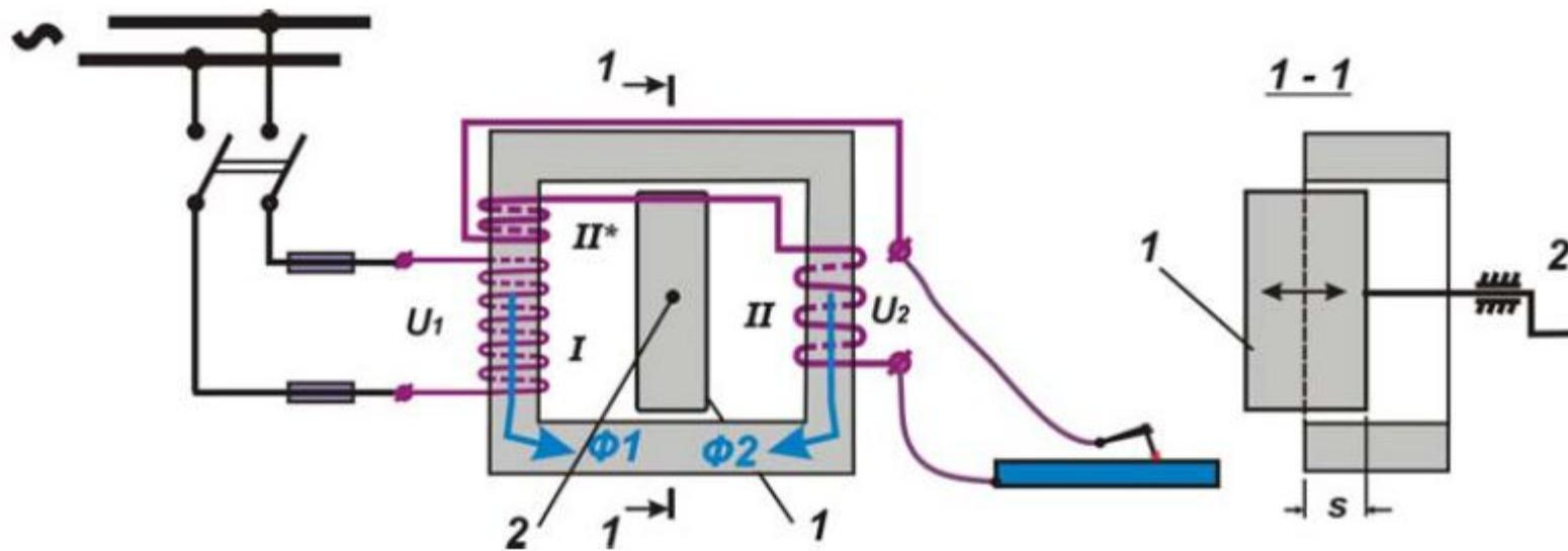
Рис. 3.4. Схема сварочного трансформаторов типа СТАН
