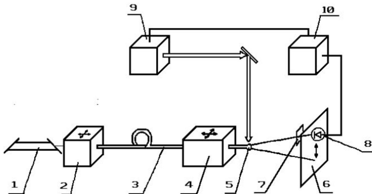
1 — He-Ne лазер, 2, 4 — элементы оснастки ТВОЭ для закрепления волокна и ввода/вывода излучения He-Ne лазера, 3 — волокно, 5 — производимый оптический компонент, 6 — экран в плоскости регистрации, 7 — интерференционный фильтр для исключения теплового облучения, 8 — фотодиод, 9 — лазер с затвором, 10 — управляющая система
