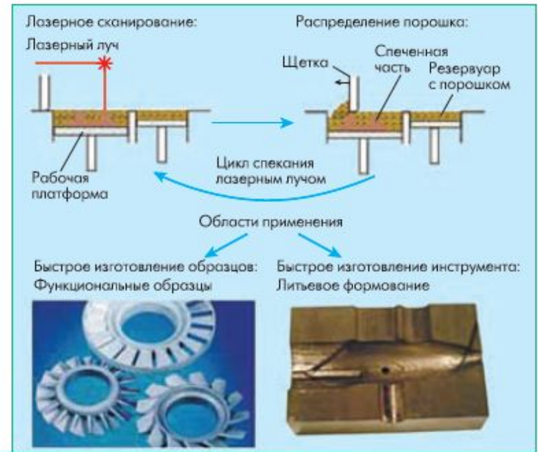
Рис. 1 Схема процесса лазерного спекания и области его использования
