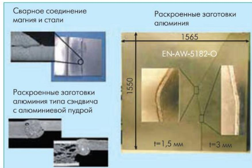
Рис. 2 Раскroенные заготовки из легких материалов
