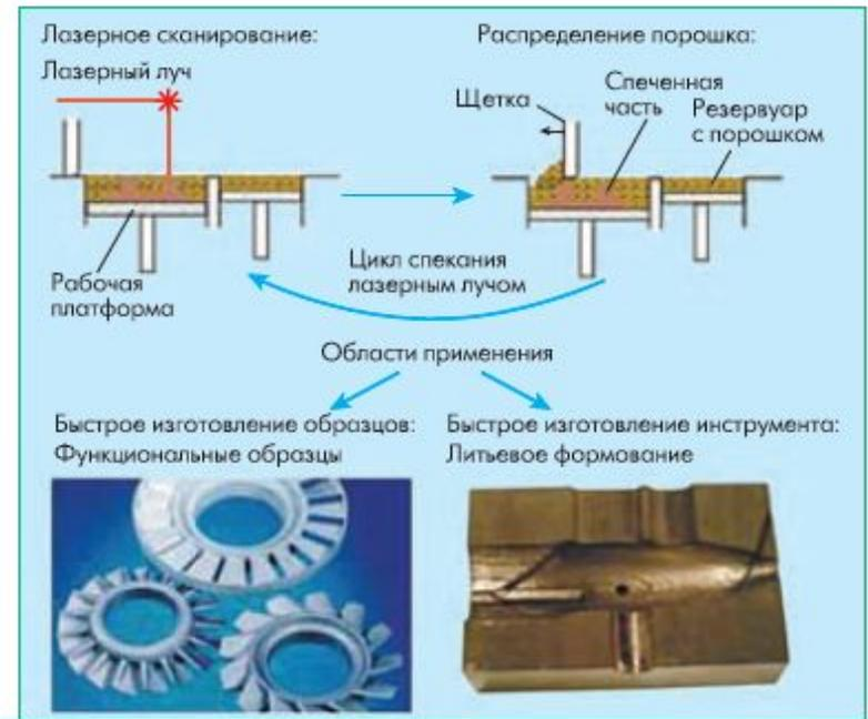
Рис. 1 Схема процесса лазерного спекания и области его использования
