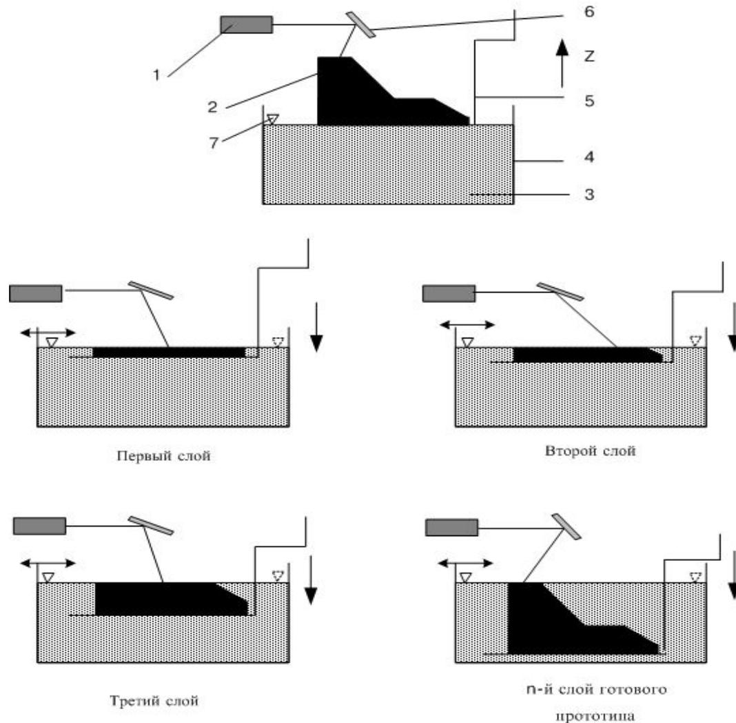
Схема получения трёхмерной твердотельной детали послойным наращиванием по способу стереолитографии: 1 - лазер; 2 - изделие; 3 - жидкий мономер; 4 - ванна; 5 - подвижная платформа; 6 - зеркало, управляющее сканированием; 7 - выравнивающий нож.
