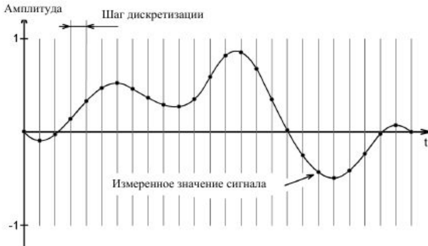
При дискретизации измеряется и запоминается уровень аналогового сигнала. Через заданный интервал времени, который называется интервалом дискретизации, процедура повторяется.
