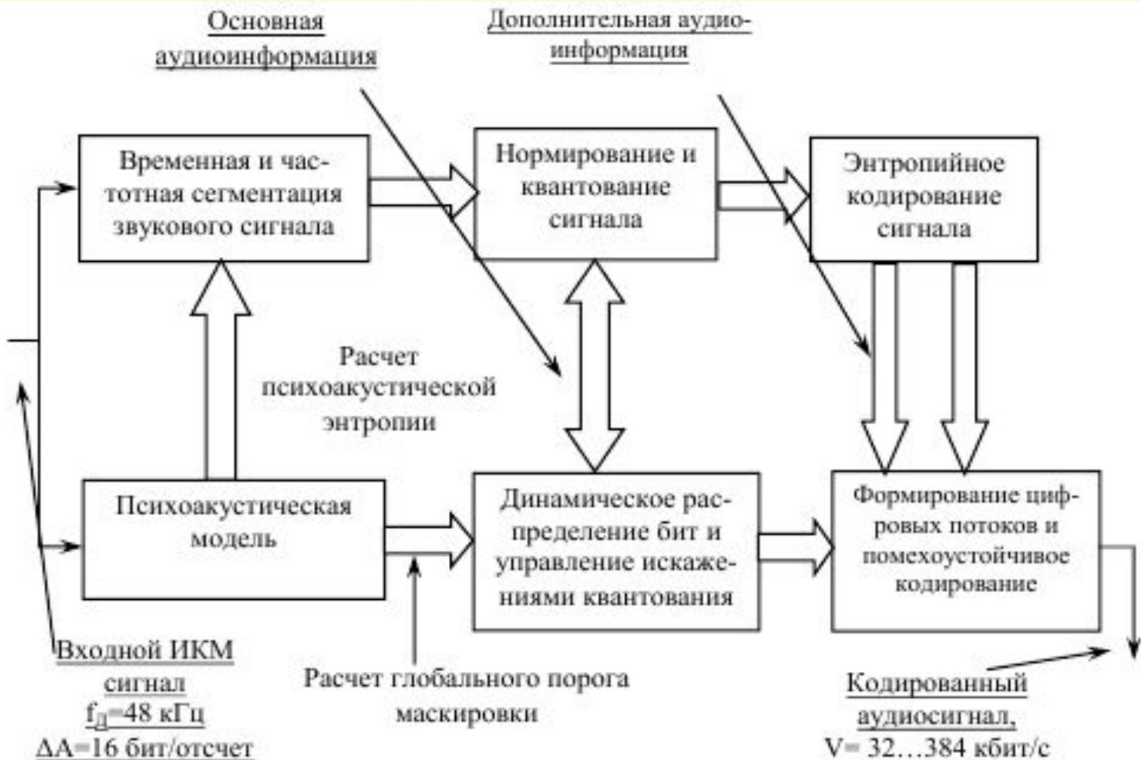
В блоке временной и частотной сегментации исходный звуковой сигнал разделяется на субполосные составляющие и сегментируется по времени. Длина кодируемой выборки зависит от временных характеристик звукового сигнала.
