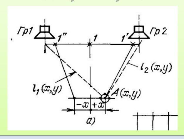
При боковом смещении слушателя расстояния l1 и l2 неодинаковые. Появляются дополнительные интенсивностные ( $\Delta N_{xy}$ ) и временные ( $\Delta \tau_{xy}$ ) различия исходных сигналов от Гр1 и Гр2 в точку прослушивания A(x,y).
