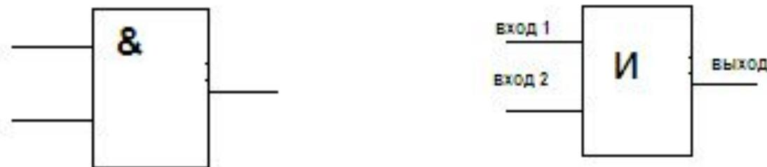
На выходе этого элемента будет сигнал 1 только в том случае, когда на все входы поступает сигнал 1. Когда хотя бы на одном входе будет ноль, на выходе также будет ноль.
