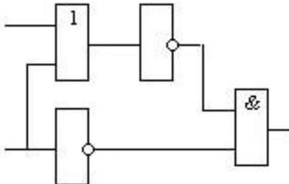
2. Составить логическую функцию по функциональной схеме и определить сигнал на выходе, если  $A=1$ ,  $B=1$ :
