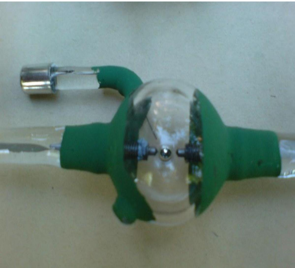
Лампы **ДРШ** (Дуговые и Ртутные Шаровые) представляют собой дуговые ртутные лампы сверхвысокого давления с естественным охлаждением. Имеют шарообразную форму и дают сильное ультрафиолетовое излучение.
