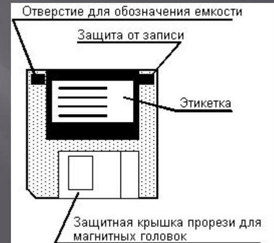
Магнітний запис оснований на властивості ферромагнітних матеріалів намагнічуватися при дії на них магнітного поля і зберігати залишкову намагніченість після припинення його дії.
