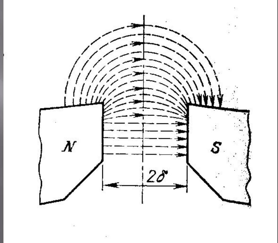
Робочий шар стрічки намагнічується то в одному, то іншому напрямку, утворюючи повздовжню сигналограму. Робочий шар стрічки з такою сигналограмою представляє собою немовби сукупність елементарних постійних магнітів, ширина яких дорівнює ширині сигналограми, а довжина – половині довжини хвилі запису
