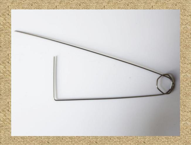
В 5-7 сантиметрах, в зависимости от размера рыбки на одном из «усов» пружины проволоку сгибаем под прямым углом
