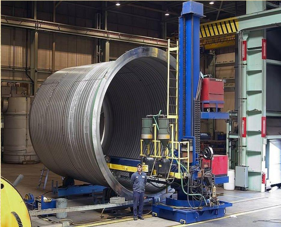
**Манипуляторы сварочные** применяются для автоматизации сварки ёмкостей, обечаек, балок и т.д. в горизонтальной и вертикальной плоскостях.
