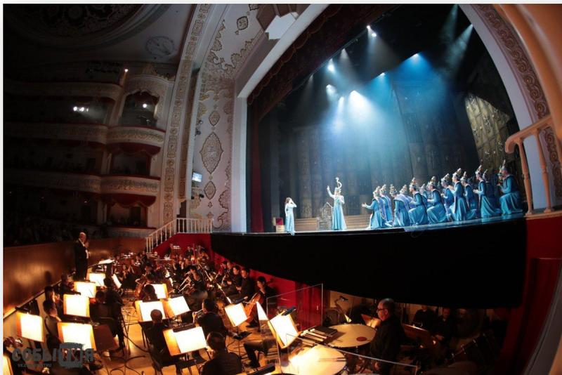
Оркестровая яма обшита резонансной сосной и оборудована плунжерной системой, то есть хор во время спектакля, в зависимости от задумки, можно поднимать и опускать прямо на платформе. Размер ямы - более 90 квадратных метров. В движение многотонную конструкцию приводит один мощный мотор.
