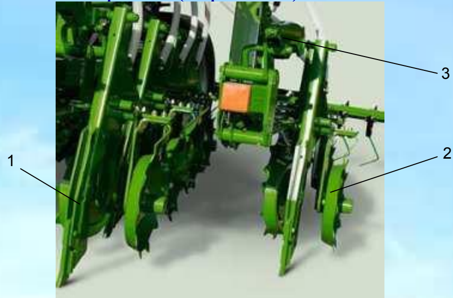
1-долотообразный сошник; 2-каток; 3-параллелограммный механизм
