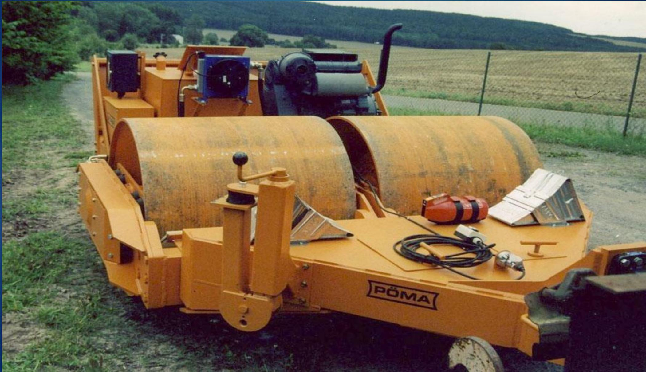
Высококачественные резиновые буфера обеспечивают демпфирование и предотвращают вибрацию на раме и на тракторе
