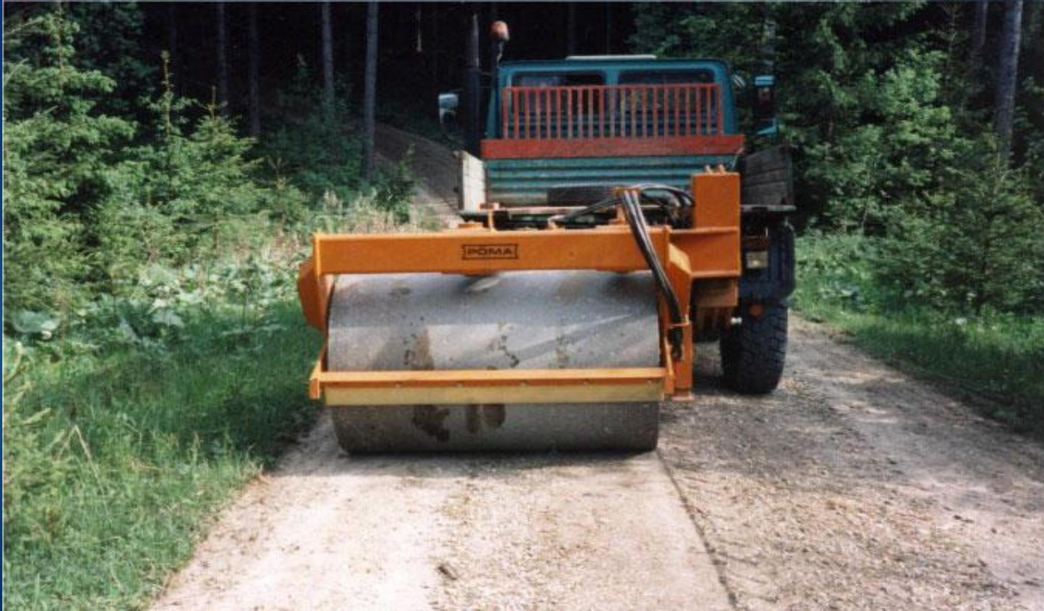
**ARW 200** — прицепной виброкаток с приводом от собственного 3-цилиндрового дизельного двигателя (двигатель катка – гидронасос – 2 гидромотора). Цепляется на DIN-ДЫШЛО
