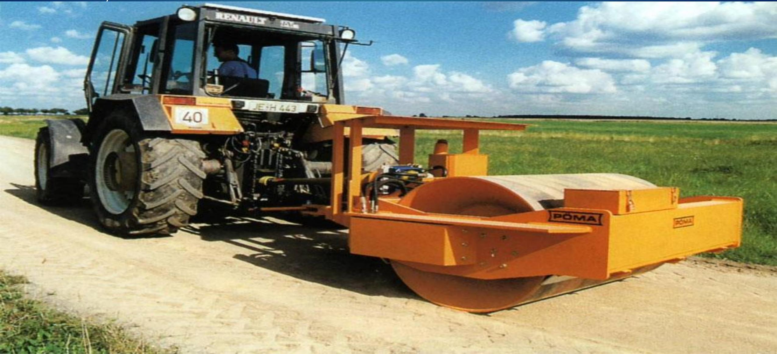
**RW 150** — навесной вибротаток с приводом от бортовой гидравлики трактора (двигатель – гидронасос – гидромотор). Навешивается на 3-точечную навеску
