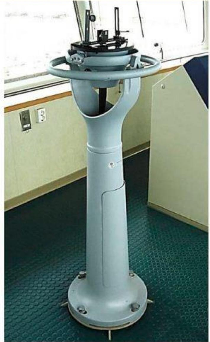
Рис. 3.5. Репитер гирокомпаса с пеленгатором, установленный на пелорусе
