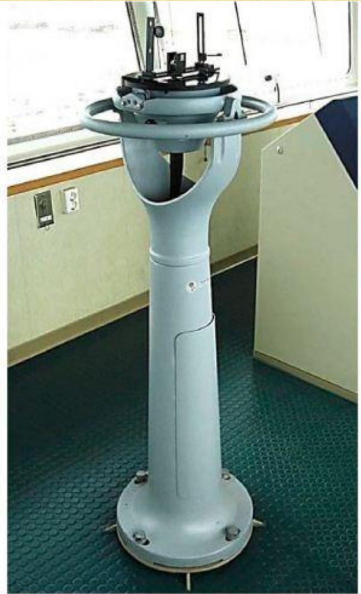
Рис. 3.5. Репитер гирокомпаса с пеленгатором, установленный на пелорусе
