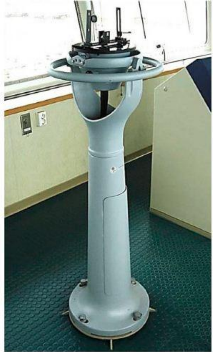
Рис. 3.5. Репитер гирокомпаса с пеленгатором, установленный на пелорусе
