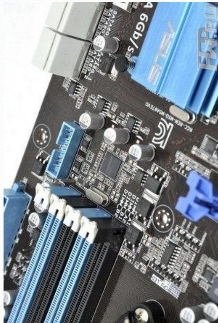
Между двумя слотами PCIe 2.0 x16 мы нашли тактовый генератор ICS 9LPRS477DKL. Специально разработанный для платформы AMD, он контролирует тактовые частоты всех основных устройств, включая центральный процессор и южный мост. За работу двух внешних портов eSATA 3.0 Гбит/с отвечает проверенный временем контроллер фирмы JMicron - JMB362.
