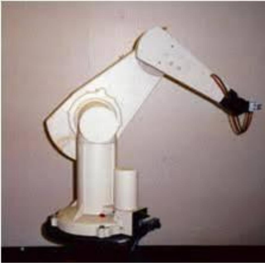
**Первый хирургический робот Unimate Puma 560 был создан в конце 1980-х в Америке. Этот робот, по сути, являлся большой рукой с двумя когтистыми отростками, которые могли вращаться друг относительно друга. Амплитуда движений – 36 дюймов. Робот имел довольно ограниченный спектр движений, использовался в нейрохирургии для удерживания инструментов при проведении стереотаксической биопсии.**
