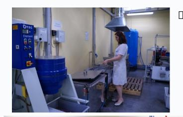
Участок промывки позволяет осуществлять высокоэффективные удаление загрязнений с поверхности деталей и сборочных единиц, с возможностью очистки крупных деталей с высокой производительностью, без использования агрессивных сред при промывки.
