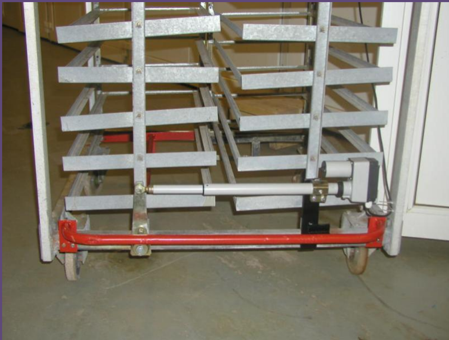
Тележка с индивидуальным механизмом поворота
