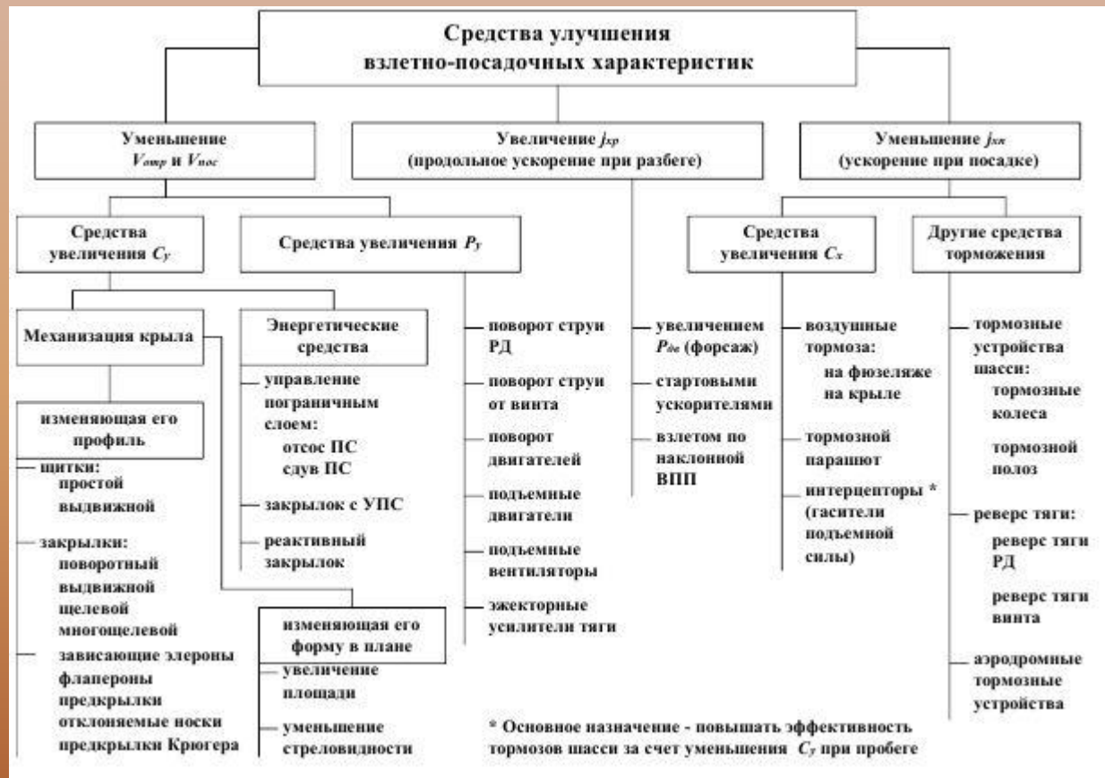
Рисунок 1 Классификация средств улучшающих взлетно – посадочные характеристика самолета
