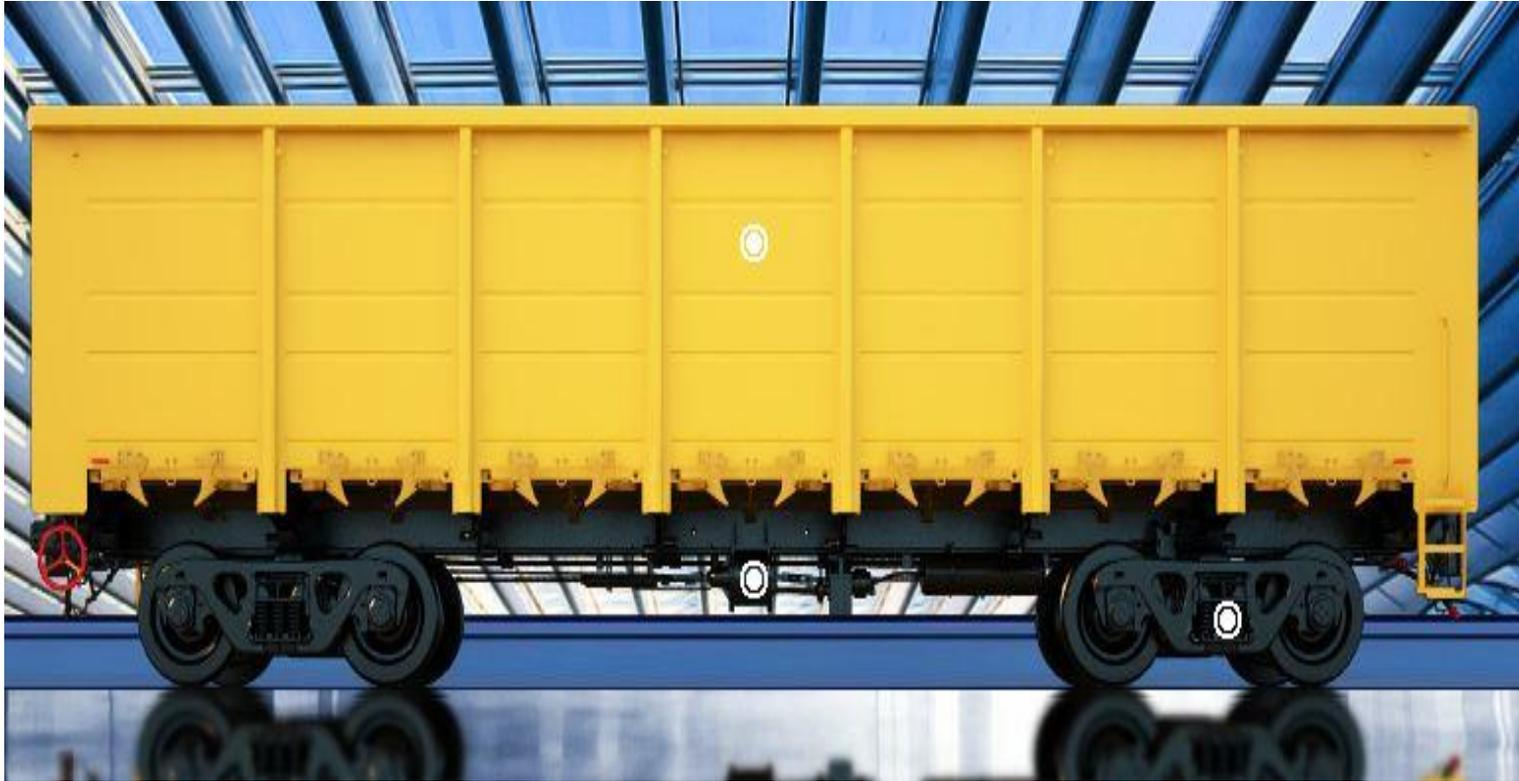
Полувагон предназначен для перевозки по магистральным железным дорогам колеи 1520 мм грузов, не требующих защиты от атмосферных осадков: насыпных, не пылевидных, навалочных, штабельных и тарно-штучных.
