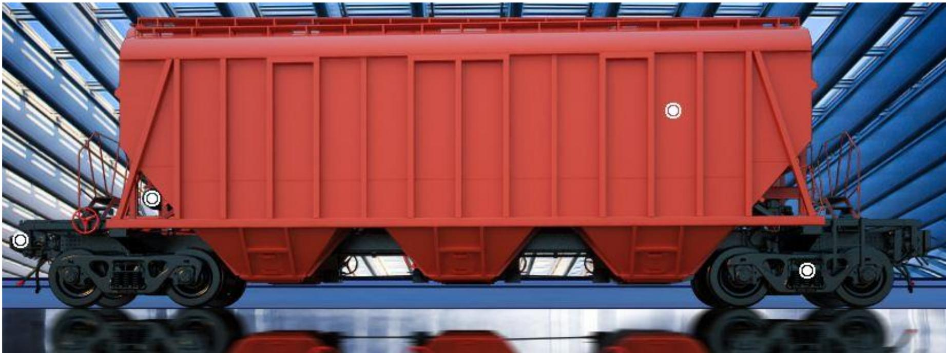
Вагон-хоппер предназначен для перевозки по магистральным железным дорогам колеи 1520 мм минеральных удобрений (в том числе агрессивных), требующих защиты от атмосферных осадков; зерна и других сыпучих пищевых грузов, требующих защиты от атмосферных осадков.
