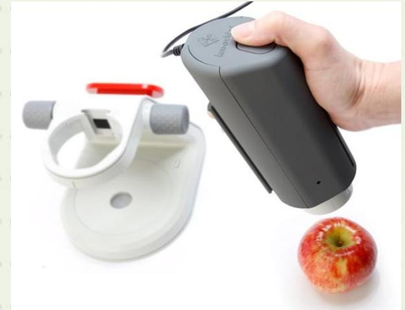
Цифровой микроскоп – разновидность традиционного оптического микроскопа, который использует оптику и цифровую камеру для вывода изображения на монитор. Позволяет не только рассматривать объекты на экране компьютера, но и делать фото- и видеосъемку изучаемых объектов.
