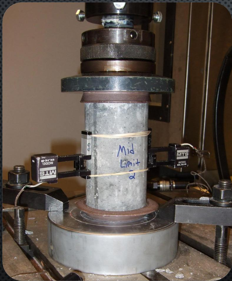
ОБРАЗЦЫ КУБИЧЕСКОЙ ИЛИ ЦИЛИНДРИЧЕСКОЙ ФОРМЫ, ИЗГОТОВЛЕННЫЕ ИЗ БЕТОННОЙ СМЕСИ, ИСПЫТЫВАЮТ ЧЕРЕЗ 28 СУТОК ПОСЛЕ ИЗГОТОВЛЕНИЯ.
