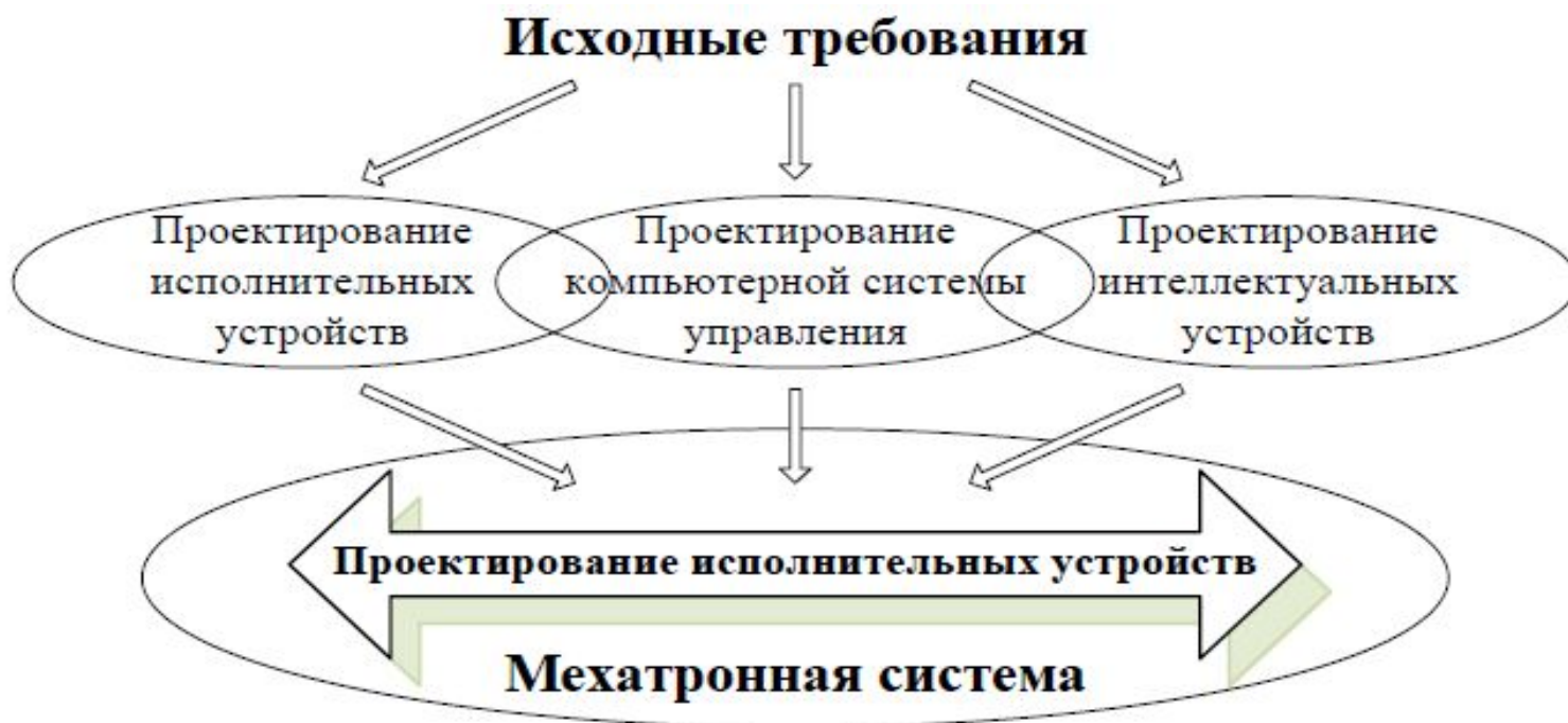
Рисунок 4.4 – Алгоритм параллельного проектирования мехатронных систем
