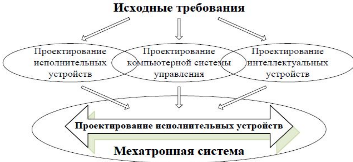
Рисунок 4.4 – Алгоритм параллельного проектирования мехатронных систем
