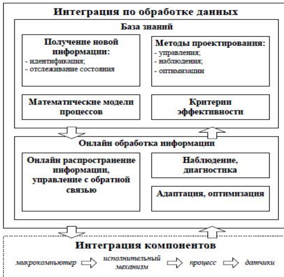
Рисунок 4.1 – Интеграция составных частей мехатронного устройства
