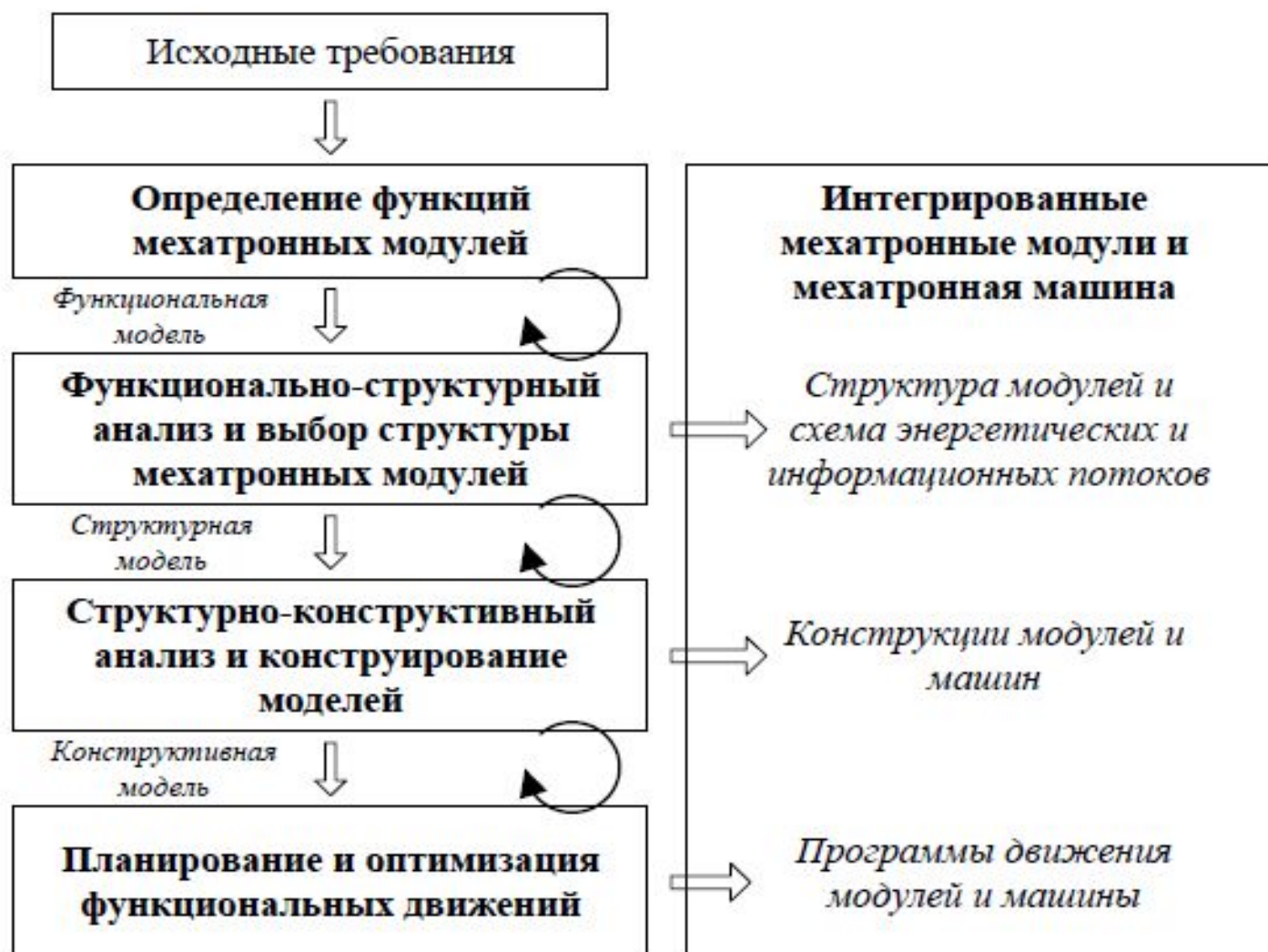
Рисунок 4.5 – Процедура проектирования интегрированных мехатронных машин
