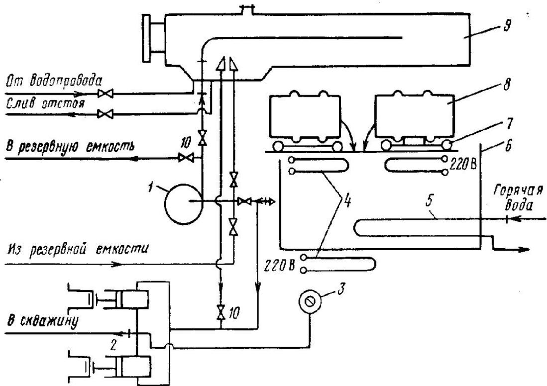
**Схема дозаторной установки БДУ-3:**
