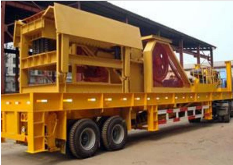
Состав и принцип работы: передвижная дробильно-сортировочная установка состоит из первичной дробильной и сортировочной станции и вторичной станции, ленточного конвейера, и т. д. Каждая дробильная станция является независимой рабочей секцией, и носит различные функции, а ленточный конвейер отвечает за перевозку и скопление между каждой дробильной станцией.
