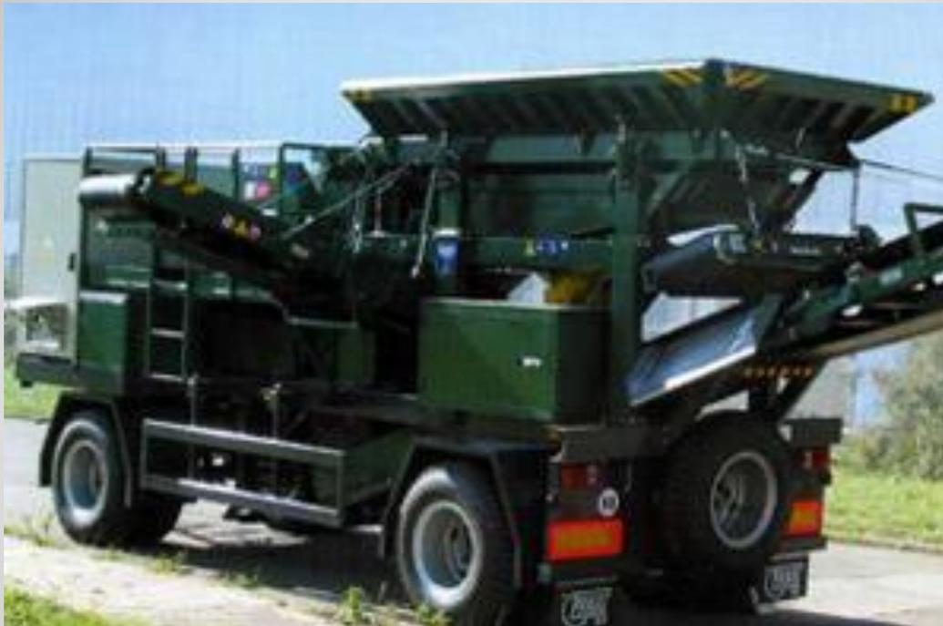
Служит для дробления строительных отходов. Материал, предназначенный для дробления, загружается колесным погрузчиком в бункер. Из бункера материал подается питателем в дробилку. Измельченный материал ленточный конвейер подает на грохот или в отвал.
