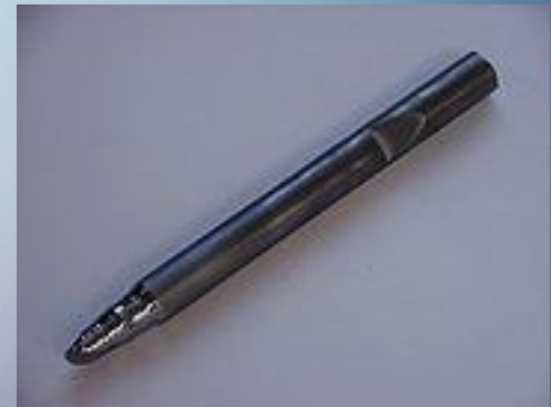
Круглый затравочный кристалл кремния с фрагментом начала оттяжки
