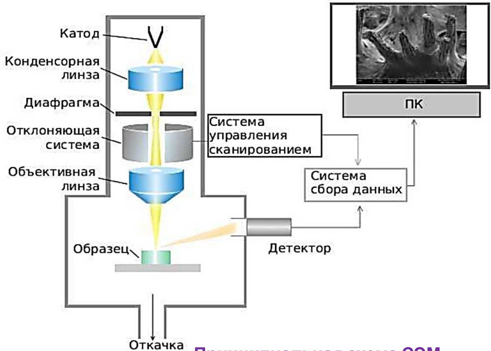
Принципиальная схема СЭМ
