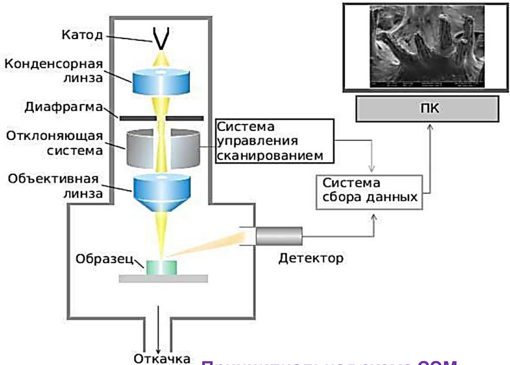
Принципиальная схема СЭМ
