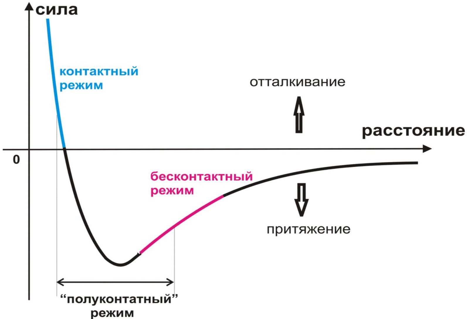
График зависимости силы Ван-дер-Ваальса от расстояния между кантилевером и поверхностью образца
