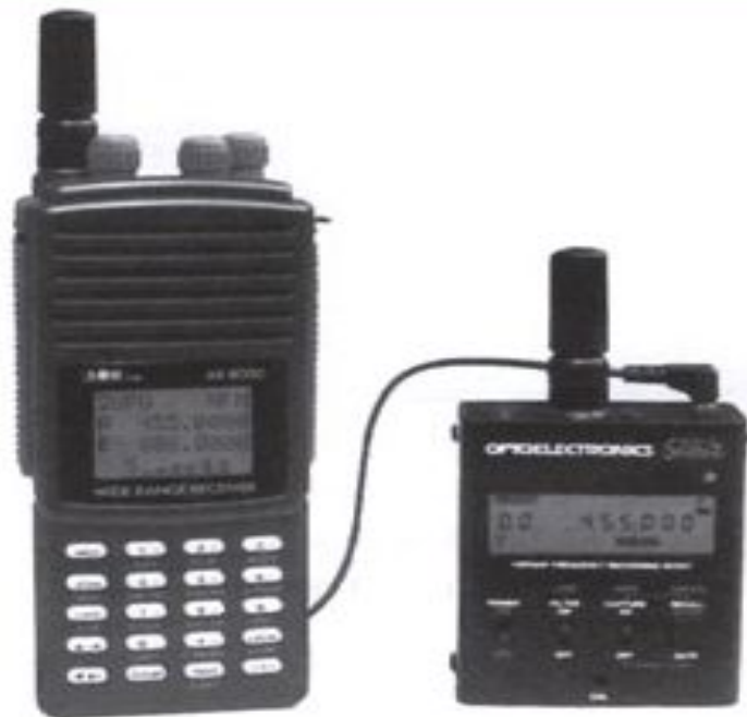
Рис. 10. Подключение сканирующего приемника к радиочастотомеру Scout
