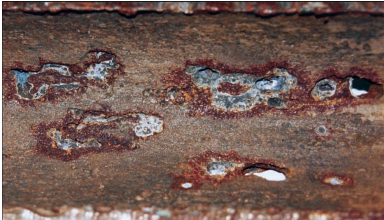
Рис. Мейза-коррозия НКТ. Глубина проникновения ~11 мм/год (Нижневартовский район, 1998 г.)
