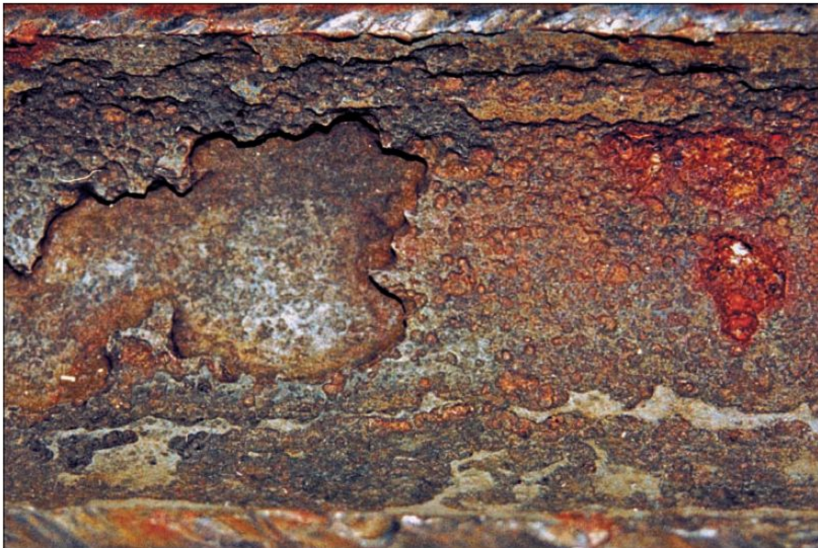
Рис. Язвенная коррозия (в различной стадии развития) и мейза-коррозия НКТ. Глубина проникновения 5–9 мм/год. Нижневартовский район, 1994 г.
