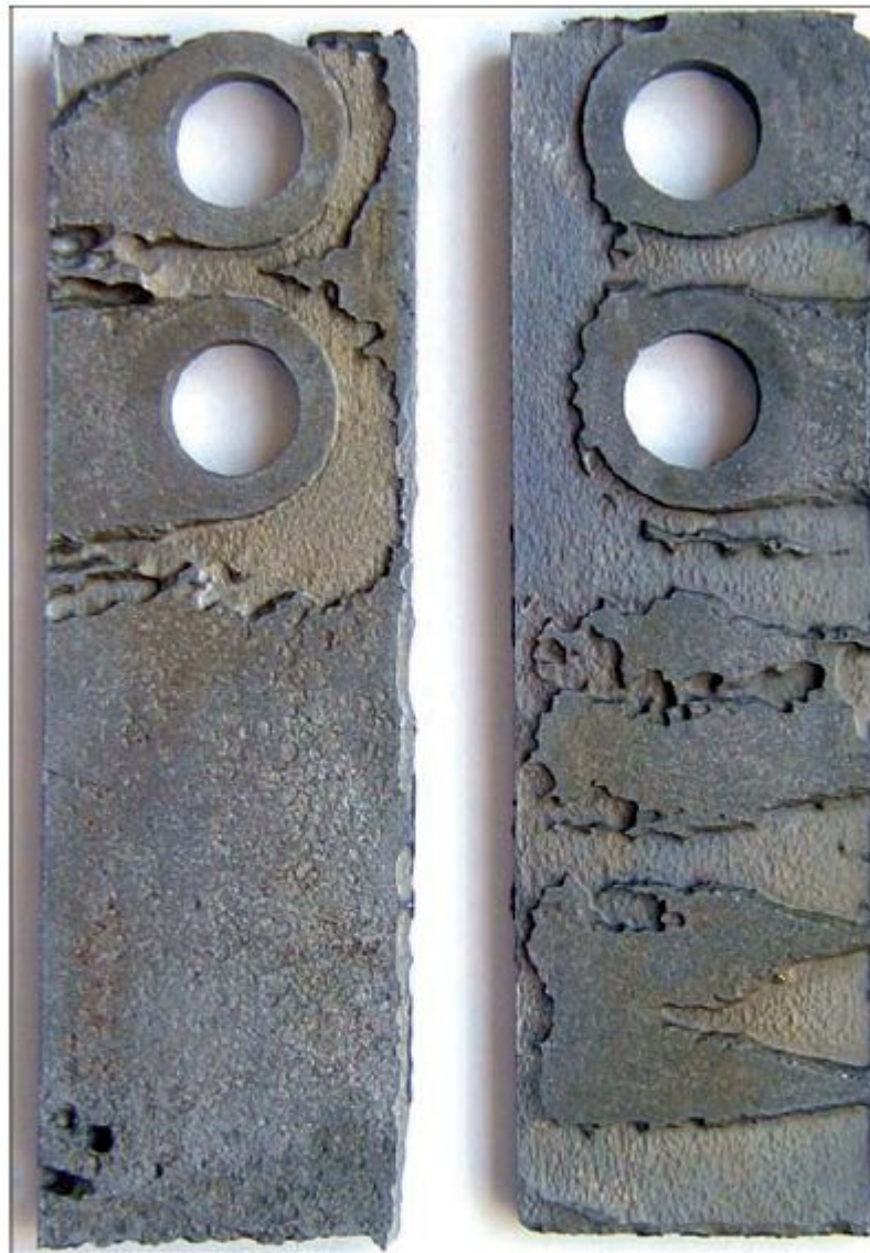
Рис. Мейза-коррозия образцов контроля коррозии весовым методом. Образцы экспонировали в трубопроводе \varnothing 89 \times 7 мм от скважины до ГЗУ 86 сут. Расход жидкости в трубопроводе 480 \text{ м}^3/\text{сут} , обводненность 70 % объемн. Глубина проникновения коррозии более 12 мм/год
