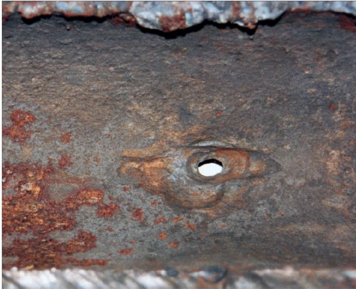
Рис. Язвенная коррозия НКТ. Глубина проникновения ~2,4 мм/год (г. Нижневартовск, 2000 г.)
